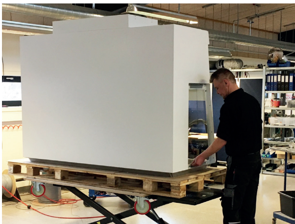
Få selv store og tunge elementer op i en højde, hvor de er til at arbejde med i en ergonomisk korrekt arbejdsstilling.
